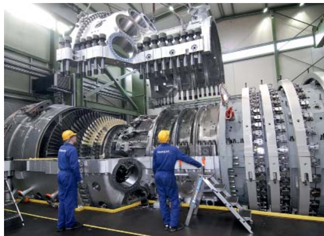
Fot. 3. Gazowa turbina dla elektrowni Irsching (fot. Siemens)
