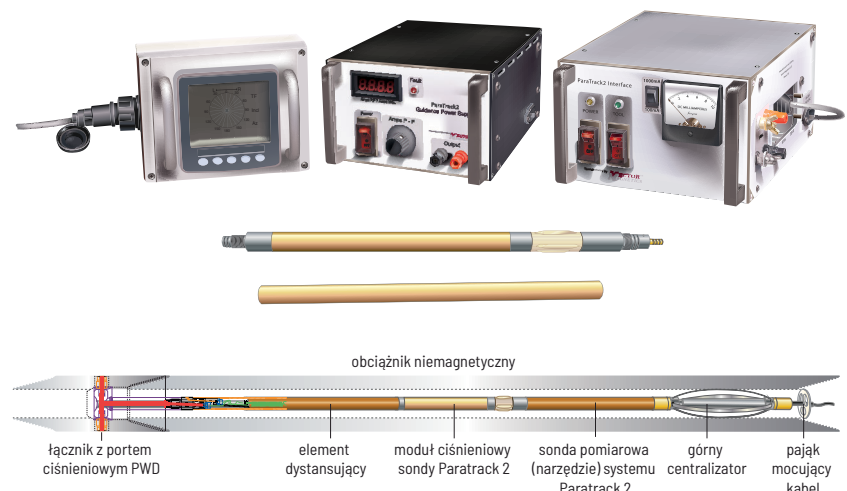
RYŚ. 5. | Elementy systemu nawigacji magnetycznej Paratrack (źródło: Prime Horizontal)
