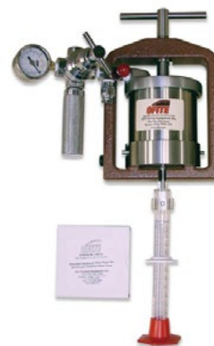
RYS. 4. | Zestaw laboratoryjny do pomiaru filtracji niskociśnieniowej API (zdjęcie: OFI Testing Equipment)
