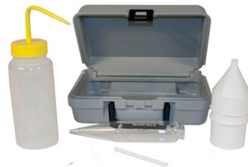
RYS. 6. | Zestaw laboratoryjny do pomiaru zawartości piasku (zdjęcie: OFI Testing Equipment)
