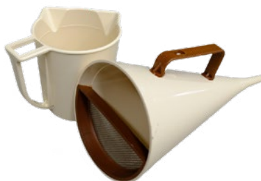
RYS. 2. | Zestaw laboratoryjny do pomiaru lepkości umownej (zdjęcie: OFI Testing Equipment)
