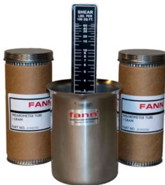
RYS. 5. | Szirometr do pomiaru wytrzymałości strukturalnej (zdjęcie: Fann Instrument Company)
